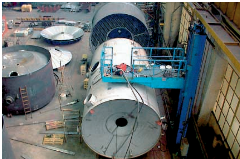
L'appareil à cuire en cours de fabrication
